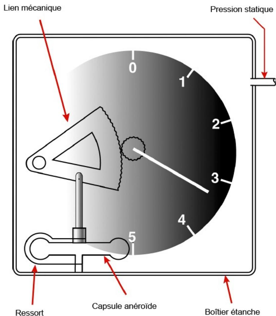
Dans un boîtier étanche se trouve une capsule anéroïde. La pression à l'intérieur du boîtier est la pression statique, mesurée par les prises de pression statique. La capsule se déforme donc en fonction de la pression ambiante. Cette déformation est transmise à l'aiguille par le lien mécanique.
